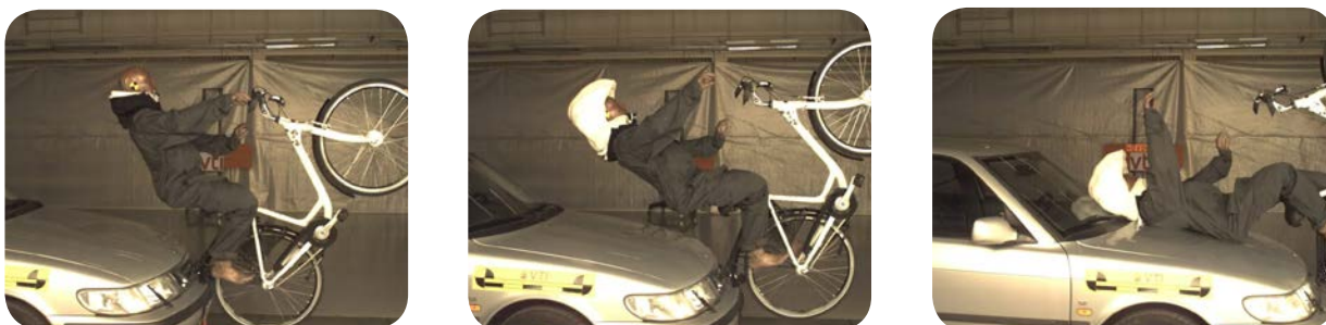
Tusentals cykelolyckor har iscensatts med hjälp av bland annat krockdockor. Ovanstående bildserie visar en krockdocka påkörd bakifrån av en bil. Airbagen fälls ut inom loppet av en tiondels sekund. Eftersom luften stannar kvar ett par sekunder i airbagen skyddar Hövding även vid efterföljande fall mot marken. Traditionella cykelhjälmår går sönder och skyddar betydligt sämre efter första islaget.
